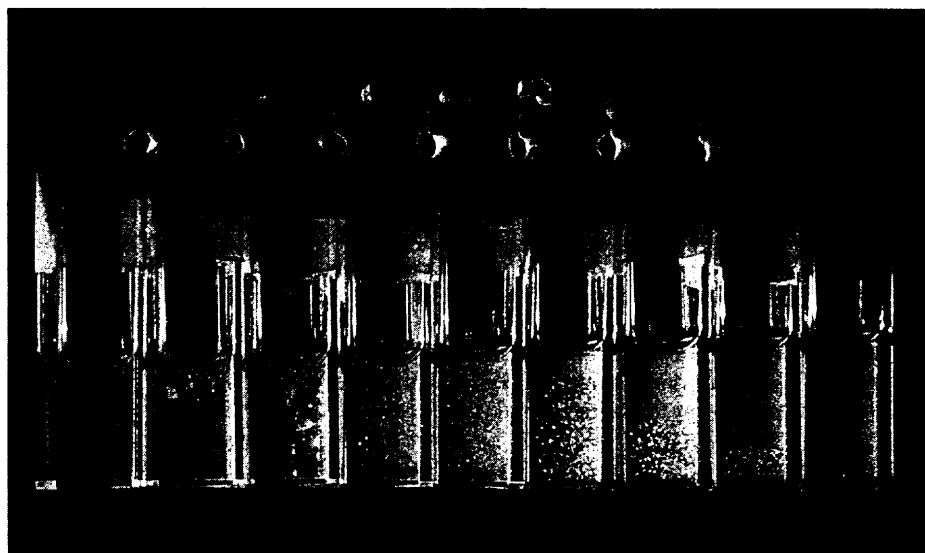
Abb. 4 (und Titelbild): Neun Proben von sterisch-stabilisierten Kolloiden (PMMA-Kügelchen) für verschiedene Volumenbrüche (von links nach rechts): \phi = 0,63, 0,62, 0,60, 0,58, 0,55, 0,53, 0,51, 0,50, 0,48 . Die Proben wurden schergeschmolzen und dann vier Tage lang equilibriert. Sie seien von links nach rechts mit den Zahlen 1–9 durchnummeriert. Die Probe Nr. 9 befindet sich in der fluiden Phase. In den Proben Nr. 6–8 sieht man eine fluid-fest Koexistenz, wobei sich die feste Phase am Gefäßboden befindet. Die Proben Nr. 4–5 zeigen nur die feste Phase, die hier stets polykristallin ist. Dagegen erkennt man in den Proben Nr. 1–3 an der Lösungsmitteloberfläche heterogen-nukleierte Kristalle. Am Gefäßboden in Nr. 1 und 2 sieht man durch das Verschwinden der Bragg-Peaks eine amorphe, glasartige Phase. Die Phasen stimmen hervorragend mit dem Hartkugel-Phasendiagramm überein. (Nach Pusey und van Megen [3]).
